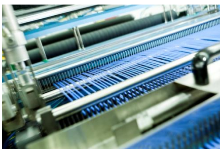
Fertigung von BEKA-Kapillarrohrmatten mit modernsten Maschinen, die eigens mit und für die Firma BEKA entwickelt wurden
