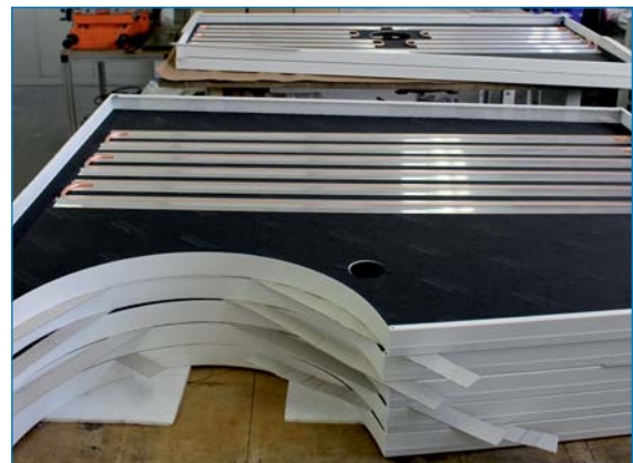
Einwölbungen für Säulen, die den Deckenspiegel durchbrechen
